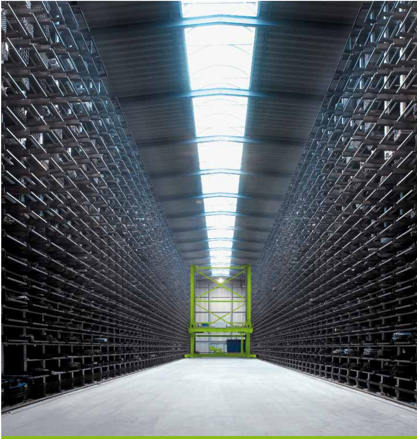
KASTO RBG- und Hochregal mit 1400 Kassetten für Aluminiumprofile
